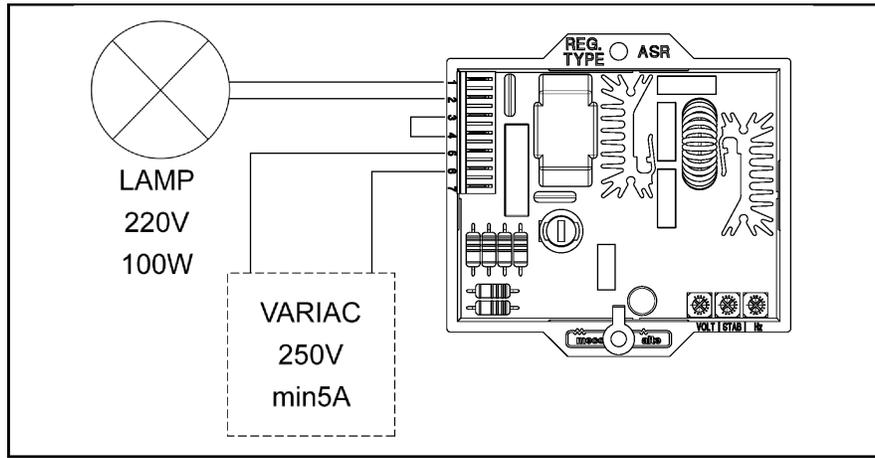
Fig. 1 Collegamento per il collaudo a Banco
