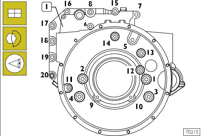
SEQUENCE FOR TIGHTENING THE FLYWHEEL HOUSING FASTENING SCREWS
