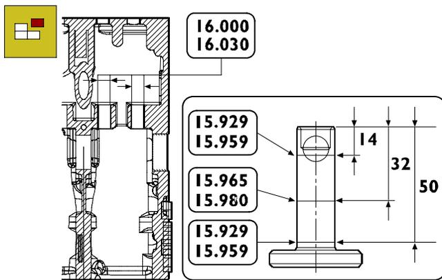
MAIN DATA CONCERNING THE TAPPETS AND THE RELEVANT HOUSINGS ON THE ENGINE BLOCK
