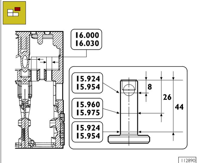
MAIN DATA CONCERNING THE TAPPETS AND THE RELEVANT HOUSINGS ON THE ENGINE BLOCK
