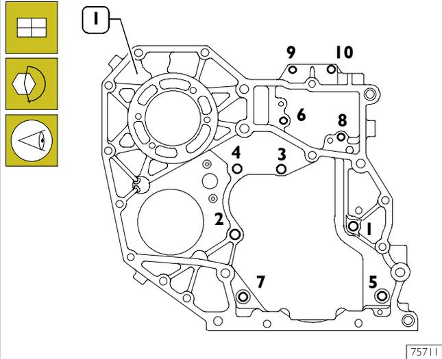
DIAGRAM SHOWING SCREW TIGHTENING TO FIX REAR GEARBOX
